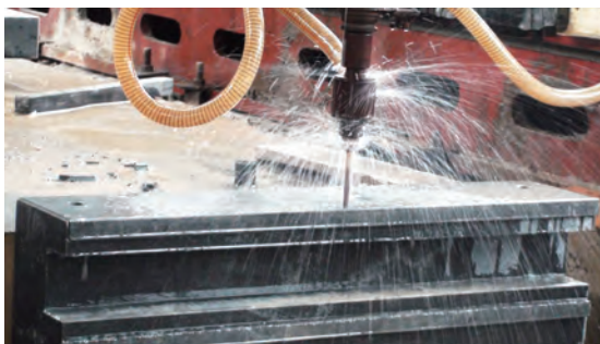
構件鑽孔磨削
