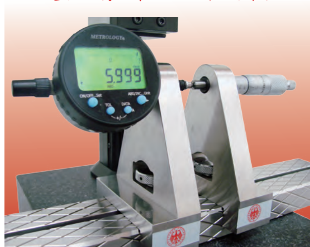
測微器頭之直接校正
